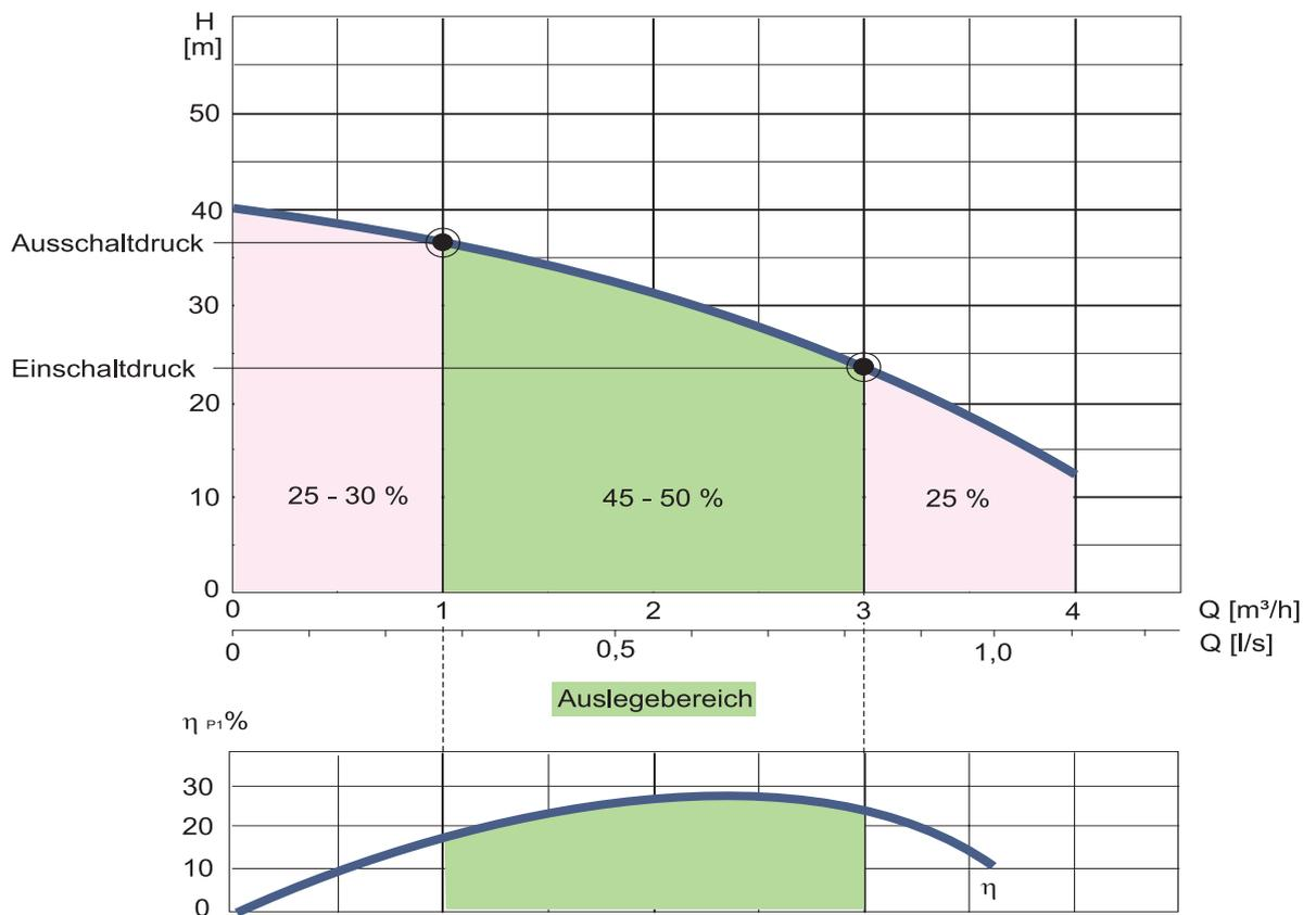
Der Auslegungsbereich mit den gewählten Ein- und Ausschalt-Drücken liegt im Bereich des optimalen Wirkungsgrades der Pumpe.
